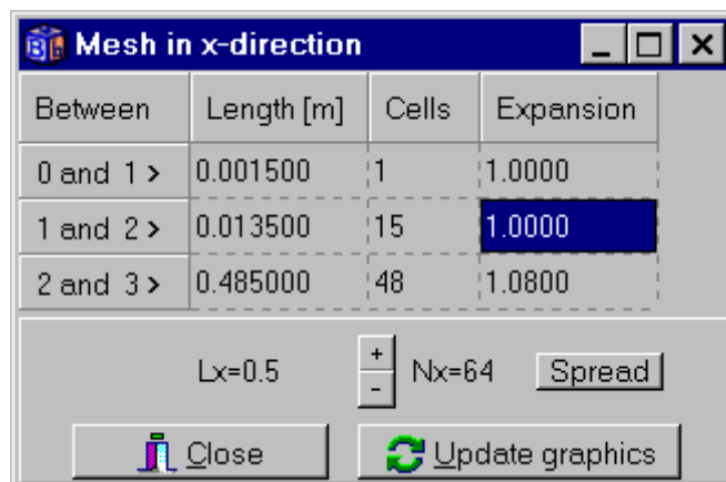
Bild 8.43: Änderung des automatisch generierten äquidistanten Berechnungsnetzes in ein expansives Raster (x-Richtung).
